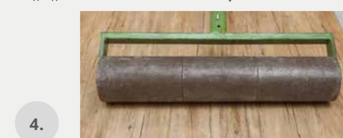
4. Zaválcování položené plochy / Rolling laid surfaces / Einwalzen einer verlegten Fläche / Прокатка уложенного покрытия / Roulage de la surface posée
